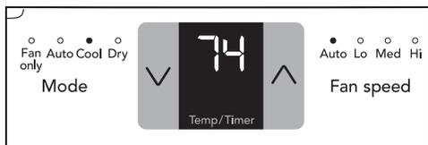
Remarque : Appuyez sur les touches vers le haut ( ^ ) ou vers le bas ( v ) ou maintenez-les enfoncées jusqu'à ce que la température souhaitée apparaisse à l'écran. Cette température sera automatiquement maintenue entre 17°C (62°F) et 30°C (86°F). Si vous souhaitez que l'écran affiche la température réelle de la pièce, suivez "Pour utiliser uniquement le ventilateur".
