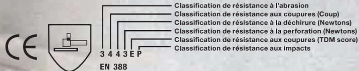
En tant que leader dans l'industrie, nos gants résistants aux coupures dans la gamme de produits Watson ont tous été testés selon les nouveaux standards ANSI F2992-15 et ISO 13997 2016 avec la machine TDM-100. En fait, 90 % de nos gants résistants aux coupures sont conformes à ce standard depuis 2011. Nous avons modifié le marquage sur nos gants pour refléter ces nouveaux standards.
