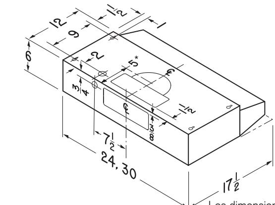
\* Point central pour une installation avec conduit rond de 7 po.
