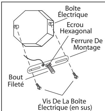
1. Posez le bout fileté à la ferrure de montage et ajuster pour qu'il dépasse un peu de la fixture lors du montage. Posez la ferrure d'installation à la boîte de sortie électrique à l'aide des vis de la boîte (en sus).
