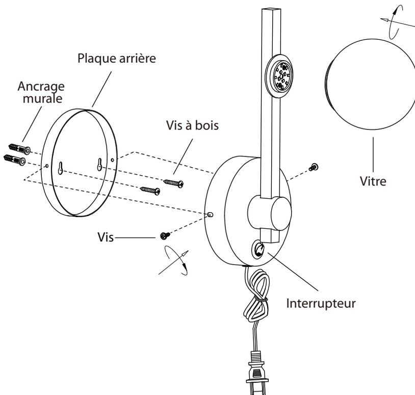
1. Retirez la plaque arrière du luminaire en dévissant les 2 vis.
