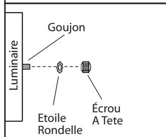
5. Poussez délicatement les fils à l'intérieur de la boîte électrique et placez le luminaire sur les goujons sur la ferrure de montage. Serrez le luminaire en place à l'aide des écrous étoilés et les écrous à capuchon.
