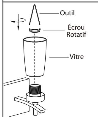
6. Retirez l'écrou fileté de la douille. Posez le globe sur la lampe et serrez en place à l'aide de l'écrou fileté.
