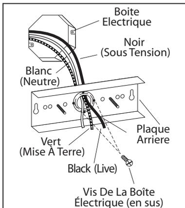
1. Faites passer les fils de la boîte de sortie dans le trou central du couvercle arrière. Alignez les trous de vis du couvercle arrière sur ceux de la boîte électrique puis attachez à l'aide de vis de boîte de sortie (non comprises).
