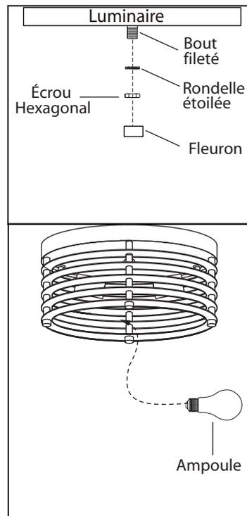
4. Posez le luminaire au bout fileté en serrant à l'aide des écrous étoilés et des écrous hexagonaux. Vissez le fleuron au bout fileté.
