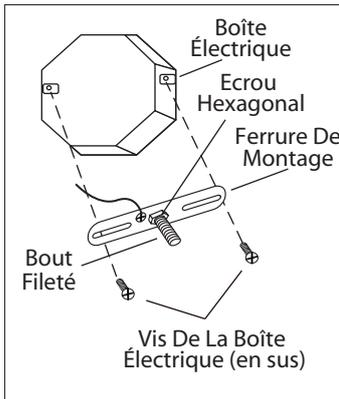
1. Posez le bout fileté à la ferrure de montage. Ajustez le jusqu'à ce qu'il dépasse le trou à l'arrière de la fixture et fixez en place à l'aide de l'écrou hexagonal. Posez la ferrure de montage à la boîte électrique à l'aide des vis (en sus).
