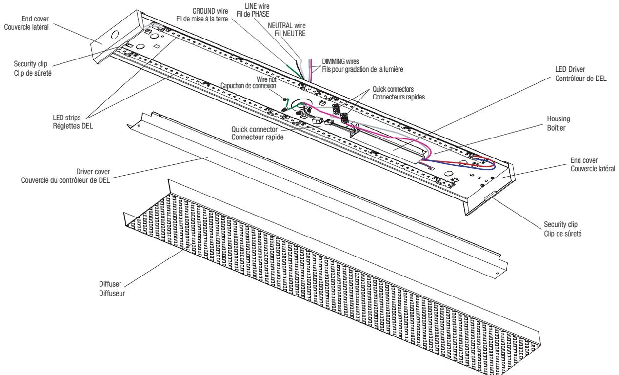
**2 DIFFUSER AND DRIVER COVER INSTALLATION/ INSTALLATION DU DIFFUSEUR ET DU COUVERCLE DU CONTRÔLEUR DE DEL**
