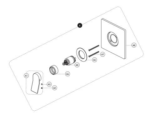
SHOWER FAUCET - TRIM FOR PRESSURE BALANCED VALVE WITH VOLUME CONTROL // ROBINET POUR DOUCHE - GARNITURE POUR VALVE À PRESSION ÉQUILIBRÉE AVEC CONTRÔLE DE VOLUME
