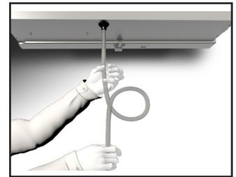
**4** Installez le tuyau de vidange faisant un piège en "P", fixez le raccord de vidange de ligne de condensat en utilisant la bride de tube fournie. Remplissez la conduite de condensat avec de l'eau.
