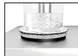
Dans le cas d'un conduit galvanisé, faites le glisser sur le collet, vissez en place et scellez le.
