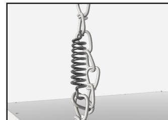
**4** Installez un ressort sur chaque chaîne. Accrochez le ressort de sorte qu'une boucle est créée dans la chaîne. Le ressort supportera le poids du VRC et absorbera les vibrations.
