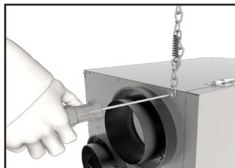
**2** Suspendez la chaîne (fournie) à chaque boulon de 19 mm (3/4 po) (fournis) situés aux quatre coins supérieurs du VRC et serrez.
