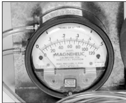
**2** Avant de prendre la lecture, assurez-vous que le manomètre Magnehelic est de niveau et indique 0. Consultez le tableau du poste de mesure des débits pour déterminer le débit d'air de l'appareil.
