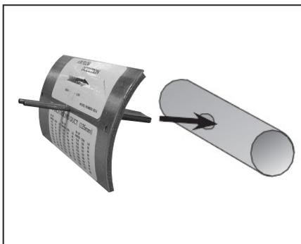
**1** Percez un trou dans le conduit et insérez le poste de mesure des débits. Assurez-vous que la flèche de sens de l'air du poste de mesure des débits pointe dans le sens du débit d'air. Fixez le poste de mesure des débits avec du ruban adhésif.
