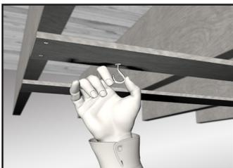
**1** Installez les crochets de fixation sur la fourrure ou les solives de plancher.
