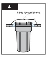
Remarque: si les conduites d'eau sont utilisées pour mettre à la terre le système électrique, les appareils électroménagers ou le téléphone, installer un fil de raccordement.
