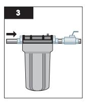
Connecter et serrer, en s'assurant que le filtre est en position droite et verticale.
