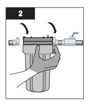
Visser le filtre à l'adaptateur après avoir couvert les fils avec du ruban Teflon<sup>™</sup> et faire une connexion serrée mais pas trop serrée.
