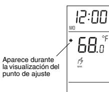
Para fijar el punto de ajuste, presionar uno de los botones  $\downarrow$  o  $\uparrow$  hasta que aparezca la temperatura deseada.
