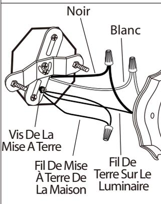
3. Vissez fermement le fil de la mise à terre (cuivre nu) sur le luminaire à la vis de mise à terre sur la ferrure de montage (en le tournant tout autour de la vis de mise à terre) puis en le branchant au fil de mise à terre de la maison avec une marrette. Posez le fil noir de la boîte électrique au deux fils noir de la fixture. Posez le fil lanc de la boîte électrique au deux fils blanc de la fixture.
