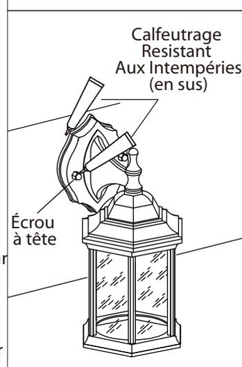
5. Après l'installation, scellez autour des périmètres du haut et des cotés avec un scellant contre les intempéries. Le dessous ne devrait pas être scellé pour prévenir une accumulation d'humidité. Appliquez une petite quantité de calfeutrage autour du périmètre entre l'écrou à capuchon et la plaque de montage.
