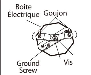
2. Placez la ferrure de montage afin que la fixture repose solidement au mur lorsque le tout sera installé.
