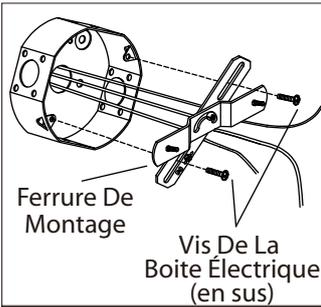
1. Posez la ferrure d'installation à la boîte de sortie électrique à l'aide des vis de la boîte. Assurez-vous que les goujons de la ferrure d'installation font face vers l'extérieur de la boîte électrique.
