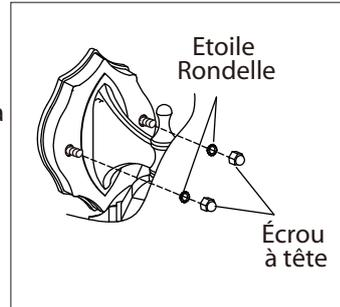
4. Une fois les connexions terminées, poussez soigneusement les fils et les marrettes dans la boîte électrique en vous assurant qu'aucun fil dénudé (sur les fils noirs et blancs) est visible des marrettes. Posez le luminaire au mur en alignant le trou(s) du luminaire avec les goujons ou tiges filetées sur la ferrure de montage. Fixez en place à l'aide des écrous à têtes et des rondelles étoilées.
