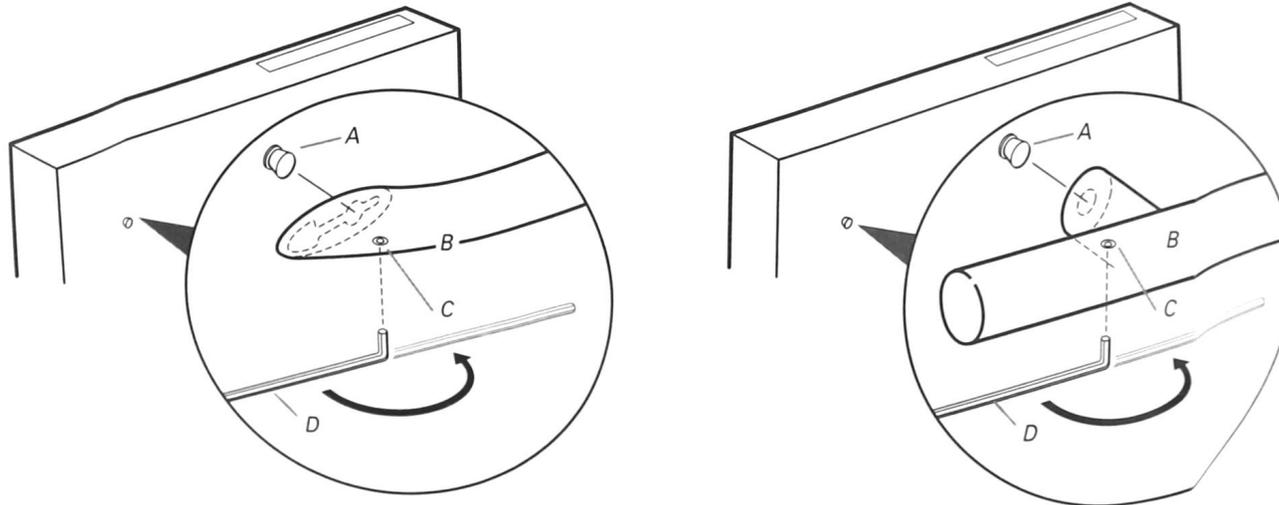
A. Mounting stud — Perno de montaje — Goujon de montage
