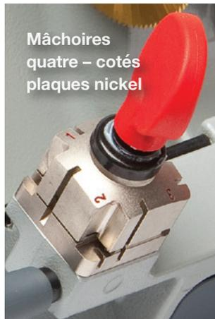
Espacement 3-1/2" (88.9 mm) entre mâchoires accueille les clés avec grosse têtes et les clés de lames longues, y compris les clés de l'automobile et cruciformes et style bascule (flip). Mâchoires plaquées nickel pour vie prolongée.
