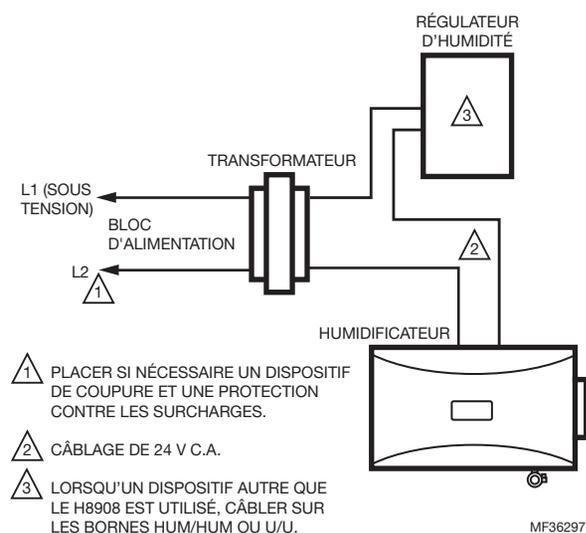
Câblage avec un autre humidistat/thermostat.
