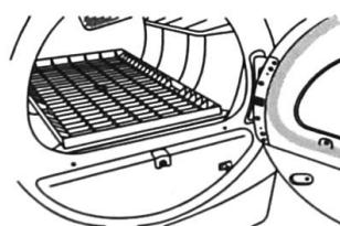
Si la grille de séchage ne s'insère pas correctement dans votre sécheuse, suivre les étapes ci-dessous pour déplacer la tige de support et l'insérer dans le trou suivant.
