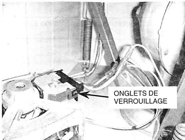
6. Branchez le connecteur du faisceau au moteur. Assurez-vous que le connecteur est complètement inséré sur le moteur et que les deux onglets de verrouillage du connecteur sont complètement engagés dans l'enveloppe de l'interrupteur.
