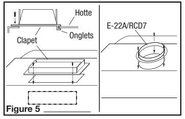
Installer un connecteur de filage approuvé à l'alvéole pour l'électricité de la hotte et guider les câbles électriques au travers de la hotte, en laissant au moins 15,24 cm (6 po) de fil pour le raccordement puis serrer.
