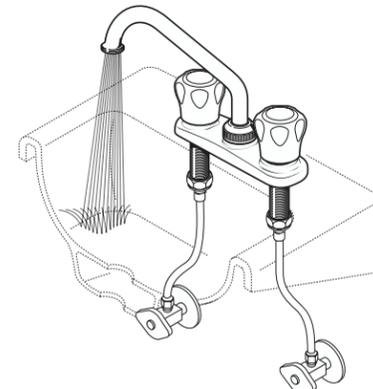
**RINCEZ L'INSTALLATION ET VÉRIFIEZ L'ÉTANCHÉITÉ.** Ouvrez les conduites d'eau froide et chaude au débit maximum pendant une minute chacune.
