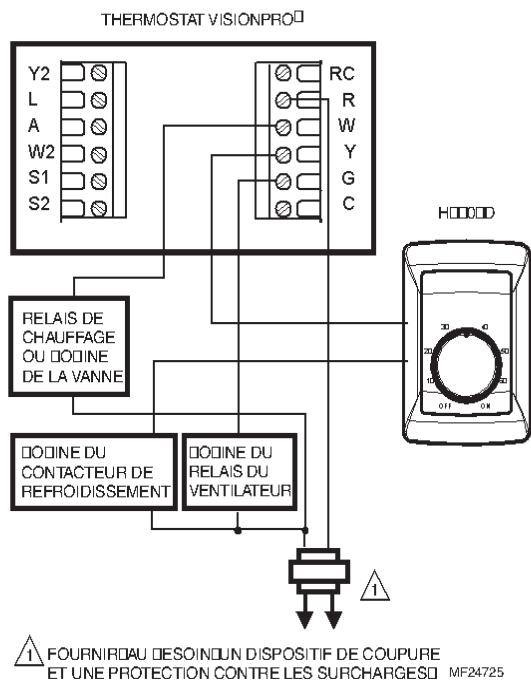
Fig. 18. Raccordement du H8908 avec un thermostat VisionPRO® pour la déshumidification.
