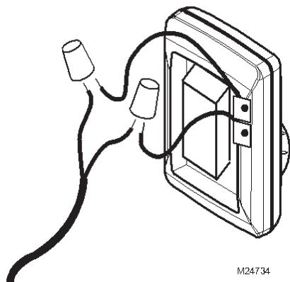
Fig. 10. Wire the humidistat.
