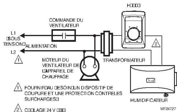
Fig. 12. Raccordement du H8908 avec asservissement du ventilateur.
