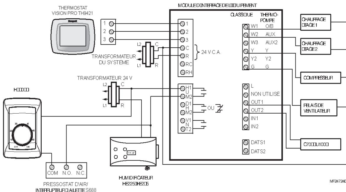
**Fig. 17. Raccordement du H8908 avec un VisionPRO® IAQ sur un système de chauffage typique à deux étages.**
