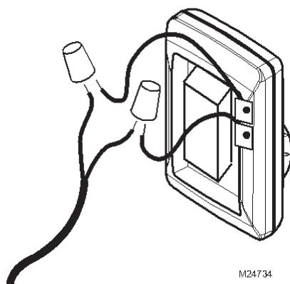
Fig. 10. Raccorder l'humidistat.
