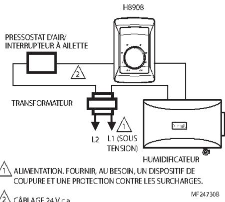
**Fig. 15. Raccordement du H8908 en série avec pressostat d'air/interrupteur à ailette et humidificateur.**
