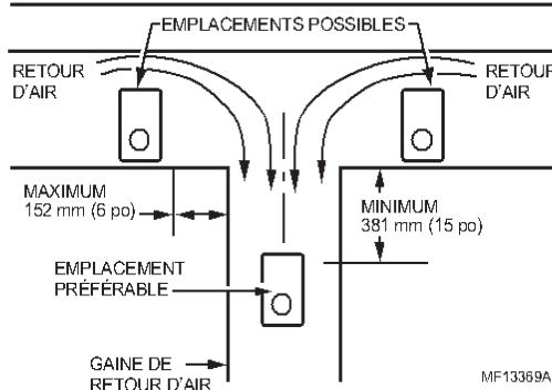
**Fig. 3. Emplacements possibles pour installation sur une gaine.**
