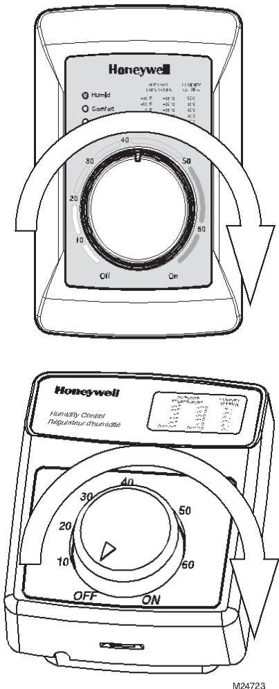
Fig. 20. Tourner l'humidistat pour le mettre en marche.
