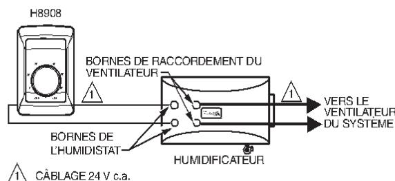
**Fig. 16. Raccordement du H8908 avec un humidificateur à vapeur.**
