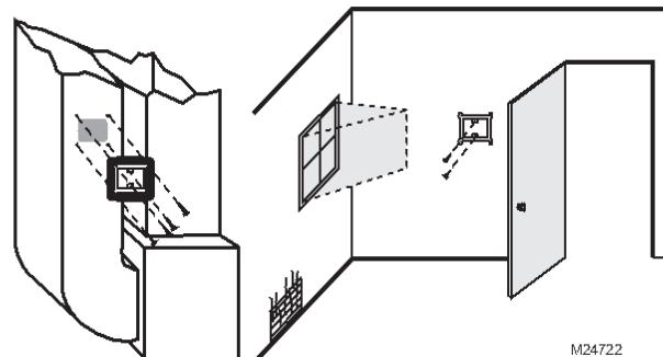
**Fig. 9. Poser la plaque de montage sur la gaine ou sur le mur.**
