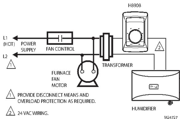
Fig. 12. Wiring H8908 with fan interlock.
