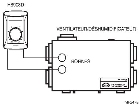
Fig. 19. Schéma de raccordement typique dans des applications de ventilation avec un HR150, HR200, ER150 et ER200 ou de déshumidification avec un DH90.
