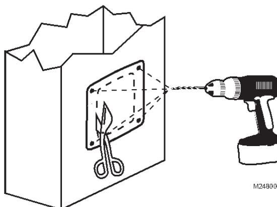
**Fig. 4. Percer les trous et découper la gaine.**
