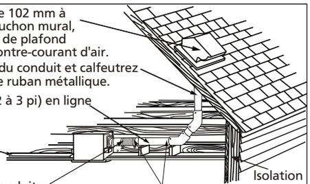
Couvrez complètement tous les joints métalliques du conduit avec du ruban métallique (les joints PVC doivent être collés)
