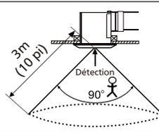
La distance de détection du mouvement est limitée à 3 m (10 pi). L'angle de vue du détecteur est 90°. La température de fonctionnement recommandée est 25°C(77°F).
