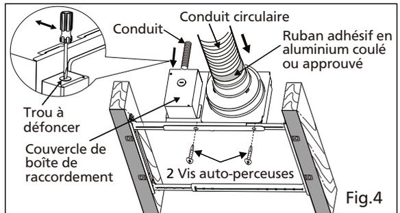
5. Installez un conduit circulaire et le fixer avec des pinces ou des liens et de le sceller avec du ruban adhésif en aluminium coulé ou approuvé. 4 pouces, 6 pouces conduit circulaire est nécessaire pour se connecter à la partie pertinente de l'adaptateur commun. (Voir Fig.4)
