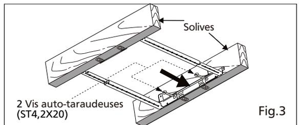
3. Réglez la longueur du support Flex-Z Fast™ que l'espacement entre les solives, et installer aux solive à l'aide de 2 vis auto-taraudeuses. (Voir Fig.3)
