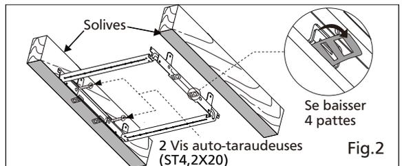
2. Se baisser 4 pattes de positionnement, installer le support Flex-Z Fast™ aux solives à l'aide de 2 vis auto-taraudeuses (ST4,2X20) (S'il vous plaît préparer les vis et mettre sur Flex-Z Fast™ support avant Flex-Z Fast™ support rapide est installé sur les livoes). (Voir Fig.2)
