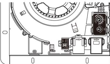
Notez qu'il n'y a qu'un seul Plug 'N Play pour insérer le module à plusieurs vitesses dans le ventilateur de modèle de base. Il y a deux Plug 'N Play fentes pour insérer le module capteur de condensation, le module de détection de mouvement ou Nite-Glo™ LED module de lumière de nuit dans le ventilateur de modèle de base.
