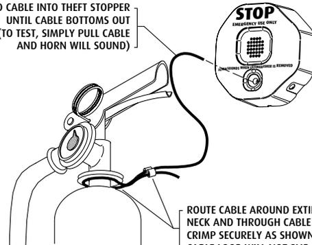
ROUTE CABLE AROUND EXTINGUISHER NECK AND THROUGH CABLE SLEEVE CLAMP. CRIMP SECURELY AS SHOWN MAKING SURE CABLE LOOP WILL NOT SLIP OVER NECK
