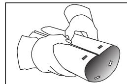
2. Fixez le capuchon d'aération au tuyau. Assurez-vous que le tuyau est bien ajusté dans la collerette. Alignez les agrafes sur celle-ci (1) pour qu'elles s'enclenchent dans les fentes du tuyau (2).
