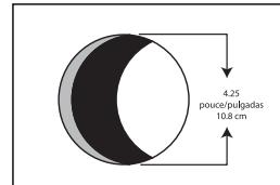
4. De l'extérieur, passez le tuyau dans l'ouverture jusqu'à ce que le capuchon d'aération vienne à plat contre la surface du mur extérieur.
