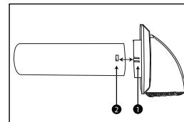
3. Pratiquez un trou de 4 \_ pouces de diamètre dans le mur ou insérez une plaque hublot de 4 \_ pouces de diamètre.
