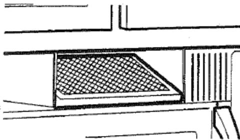
3. Insérez le filtre dans la partie supérieure de l'ouverture. Il se placera à une position angulaire sur les deux languettes de support latérales, le bord avant du filtre reposant sur la partie inférieure avant de la gaine de ventilation.
