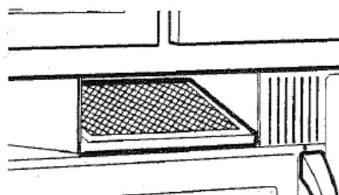
3. Inserte el filtro por la abertura superior. Éste descansará en un ángulo y las arejillas de los apoyos laterales con el extremo frontal del filtro descansando en el fondo frontal de la abertura del conducto de aire.
