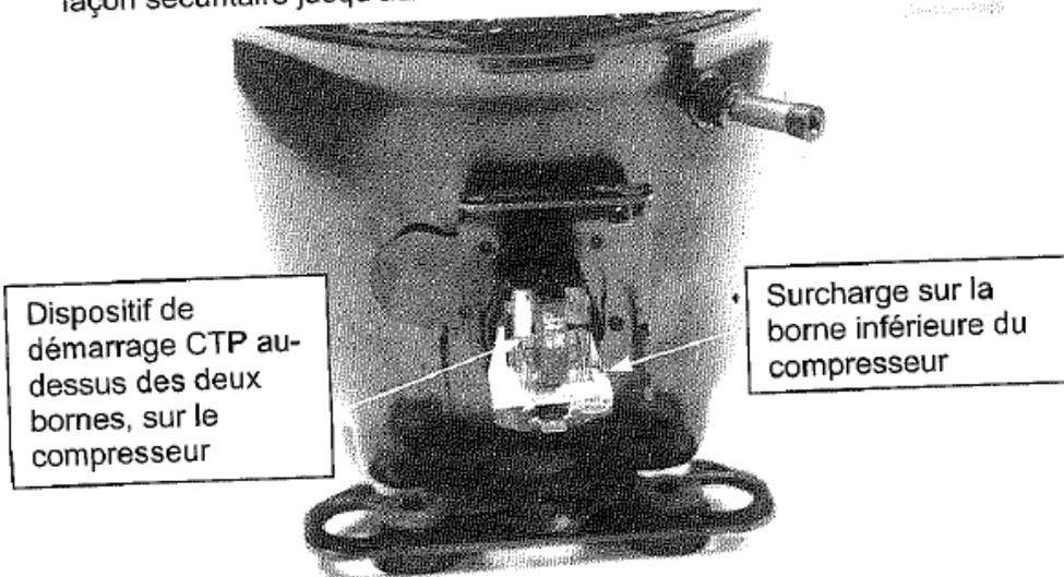
7. Installer le cavalier inclus dans la trousse sur la borne gauche (numéro 2 sur le relais) du dispositif de démarrage CTP, comme illustré ci-dessous.
