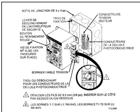
Fig. 2—Installer le régulateur après avoir raccordé les conducteurs tension secteur.
