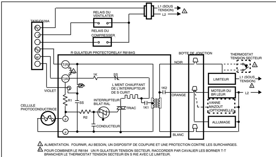
Fig. 1—Schéma de raccordement type du Tradeline R8184G avec voyant.
